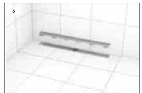
... erfolgt das Verfliesen und Verfugen. Mit dem Einsetzen der Abdeckung ist die Montage abgeschlossen. Die Abdeckung kann zu Reinigungszwecken jederzeit einfach entnommen werden.
