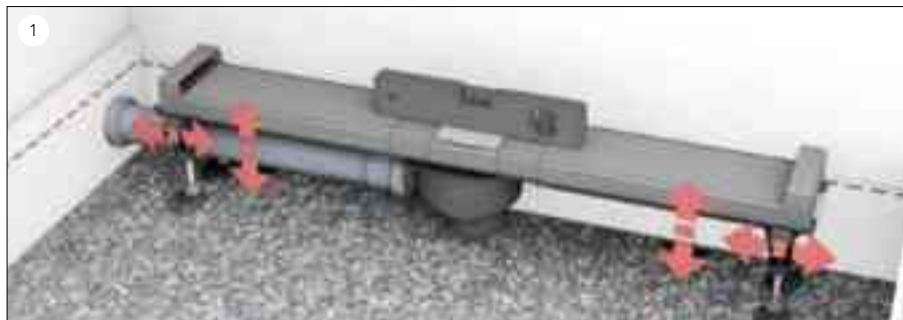
Die geschlossene Rinne wird im Raum platziert und ausgerichtet. Mit den optional erhältlichen Montagefüßen lässt sich das einfach bewerkstelligen. Das Abflussrohr kann platzsparend unter der Rinne verlegt werden.
