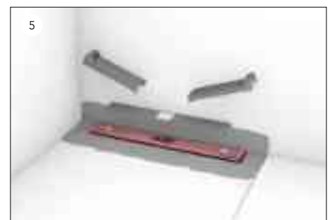
Nach dem Verfüllen mit Estrich wird der Bauzeitenschutz entfernt, die erste Schicht der Verbundabdichtung aufgetragen...
